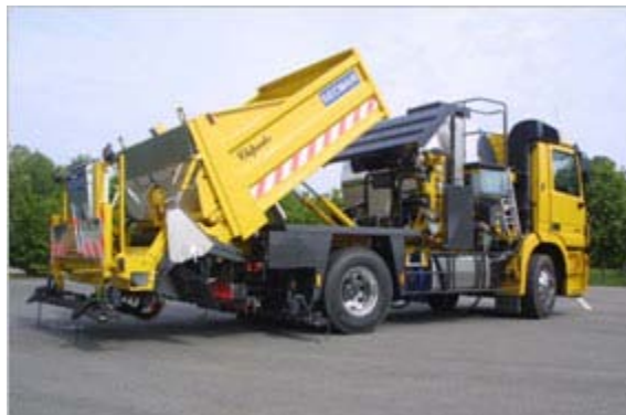
چپ سیلر 26 نصب شده بر روی کامیون
